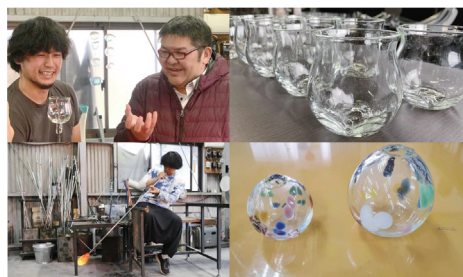
▲太陽光パネルを熱分解して抽出したガラスを100%使用したRebornglass
