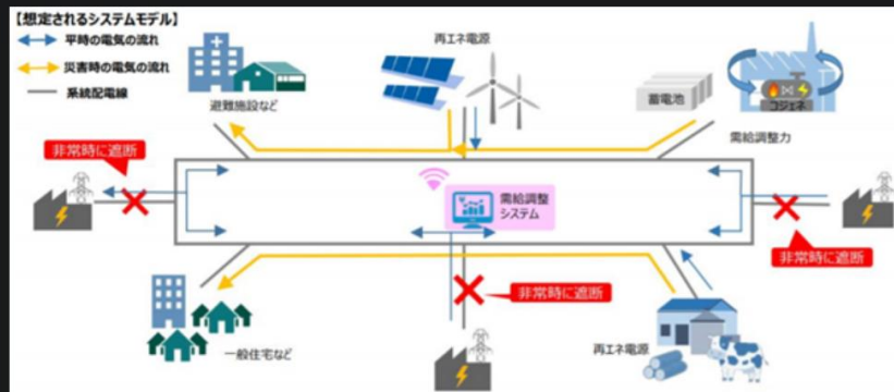
図2.4 地域マイクログリッドのシステムモデル例 (引用：地域社会における持続的な再エネ導入に関する情報連絡会（第4回） 資料6）
